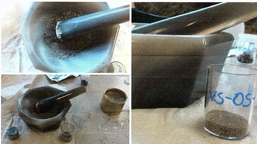
Figura 9: Preparação das amostras para a obtenção das curvas termomagnéticas. Foram preparadas as amostras VS-01, VS-02, VS-05, VS-06, VS-09, VS-10, VS-12, VS-15 e VS-16.
